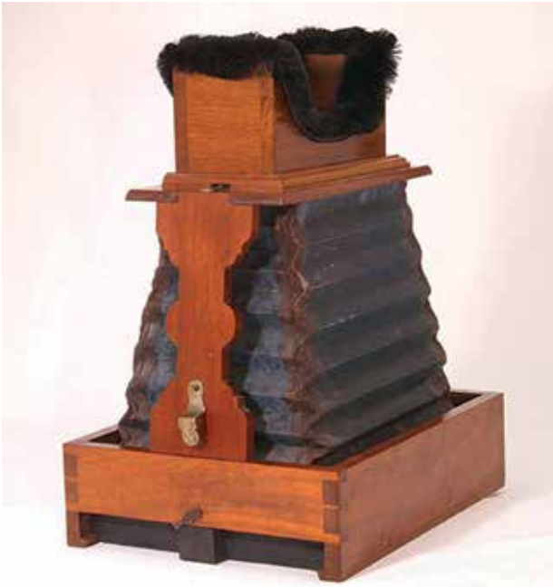
Figuur 6. Cryptoscoop die is uitgevoerd met een balg, zodat deze inklapbaar is geworden.
