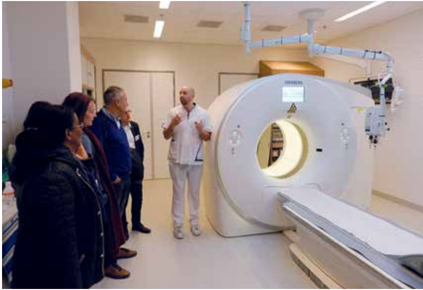
Figuur 2. Siemens Somatom Force CT-scanner met dubbel buis-detectorsysteem voor snelle hartscans en pediatrische CT zonder anesthesie.
