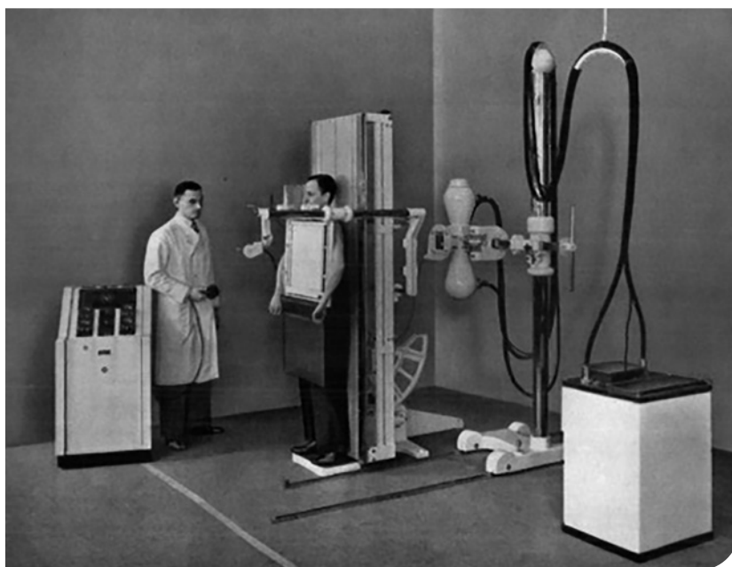
Het hele Medio-D-röntgenapparaat van Philips in 1941. Rechts de ijzeren tank gevuld met olie met de hoog-voltagegenerator, links de bedieningskast. In het midden de standaard die het doorlichtingsscherm of de röntgenfilm draagt. Daarachter de röntgenbuis aan een verplaatsbaar statief. Bron: Philips Technical Review, 1941 vol 6, no 1.
