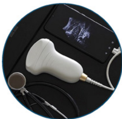
Figuur 1: De BabyChecker maakt gebruik van een draagbare echotransducer die is verbonden met een smartphone (links). Voor de opnamen wordt gebruikgemaakt van een sweep-protocol van 6 opnamen (midden) waarbij de gegevens real-time worden geanalyseerd met AI. Aan het eind van de opnamen wordt het resultaat op het scherm getoond.
